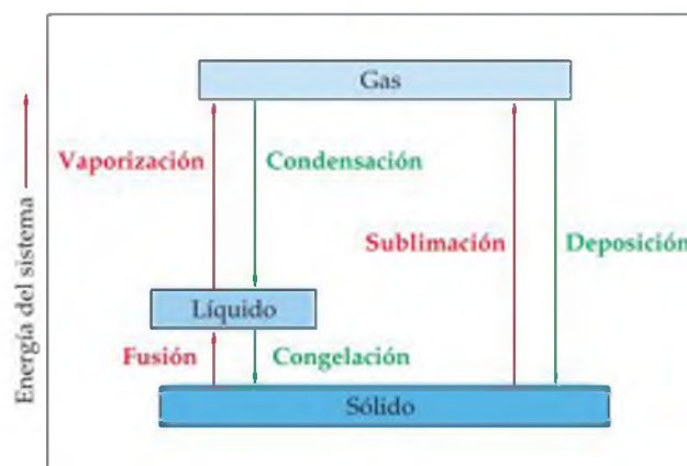
▲ Figura 11.17 Cambios de fase y sus nombres asociados. Los cambios y los nombres indicados con flechas rojas son endotérmicos, y los indicados con verde son exotérmicos.
